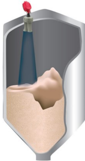
Figura 2.8: Laser 3D para estimativa de armazenamento em silos [33].
