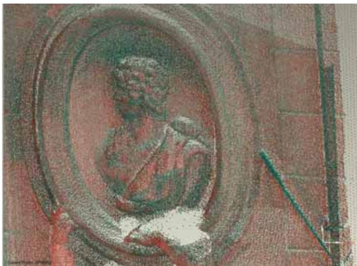
“battere” con il laser; il *laser scanner*, non necessitando la presenza del rilevatore, durante la “scansione” batte milioni di punti che spesso non sono di alcuna utilità ma anzi appesantiscono enormemente il *data base* da rielaborare successivamente.
