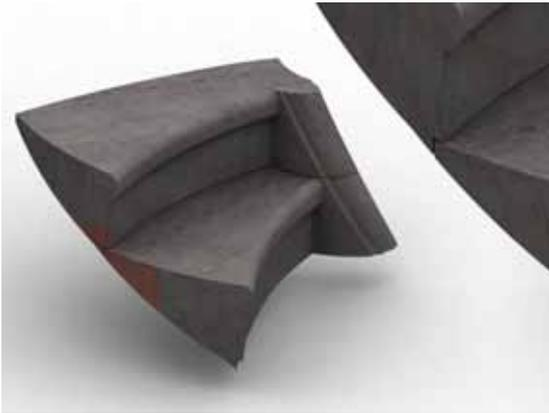
**Fig. 15** Soluzione di collegamento fra i gradini.
