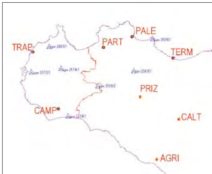
Figura 12 - Posizione delle SP e dei vertici IGM95 utilizzati per l'inquadramento in ETRF89-IGM95
