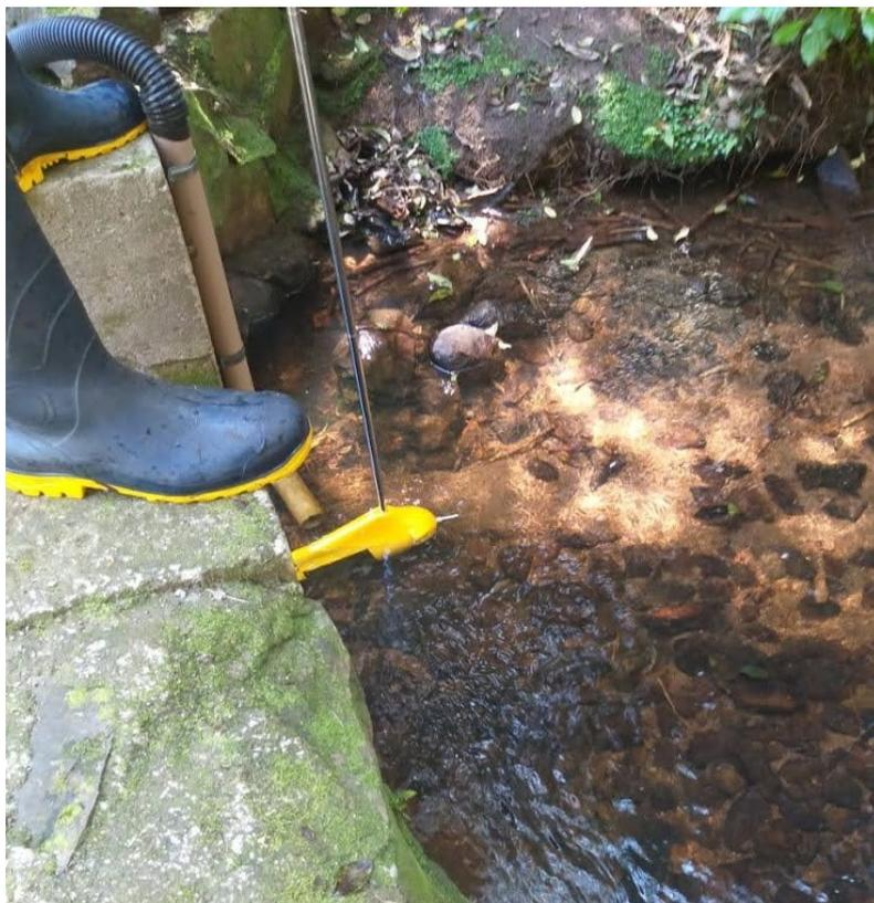
Figura 14. Coleta de CSS com o amostrador DH48.
