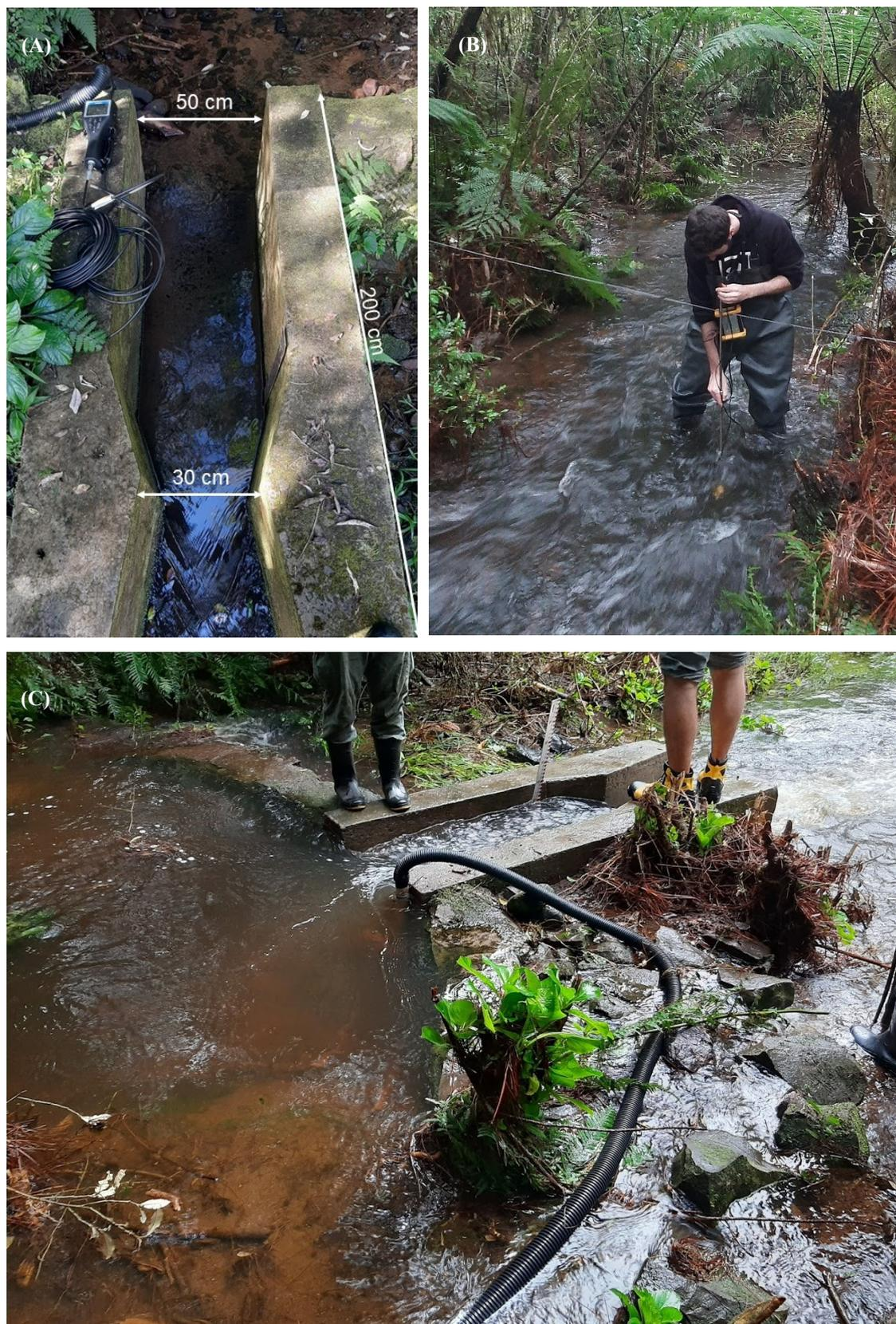
Figura 13. (A) Dimensões da calha parshall. (B) Medição a montante da calha com o micromolinete. (C) Situação de extravasamento da calha parshall.
