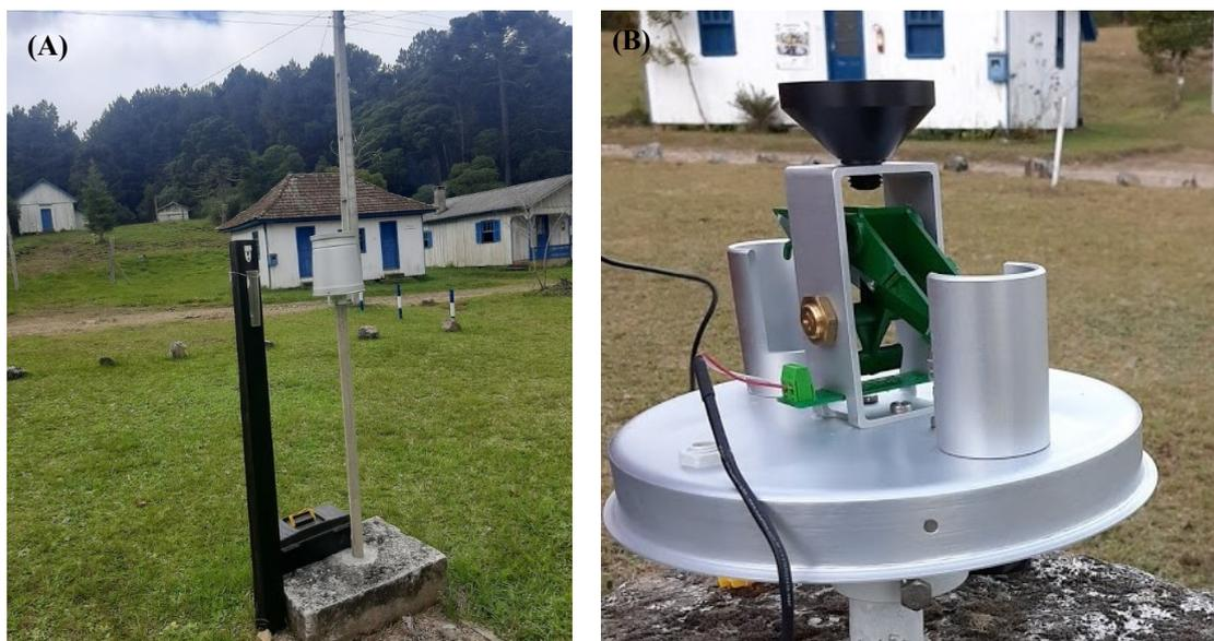
Figura 12. (A) Pluviômetros utilizados. (B) Sistema basculante do registrador de chuva.
