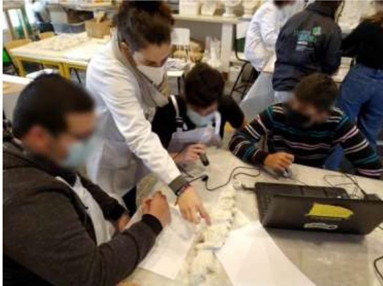
**Fig. 40 - Aquisição de microfotografias através do @Dino-Lite com luz branca e ultravioleta, Turno 2.**
