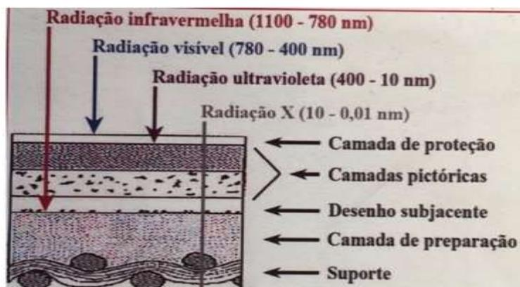
Figura 14 - Esquema da penetrações das diferentes radiações numa pintura.
