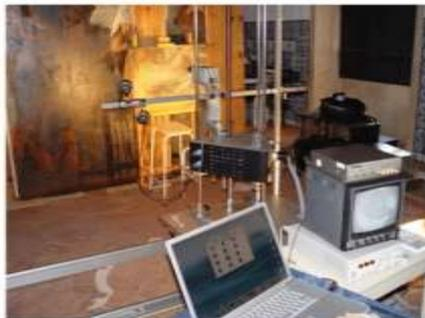
**Figura 9** - Realização da técnica de refletografia de infravermelhos. Fonte: [https://www.researchgate.net/figure/figura-8-Registo-de-refletografia-de-infravermelho-Obs-Fotografia-efectuado-pelo\\_fig1\\_311714860](https://www.researchgate.net/figure/figura-8-Registo-de-refletografia-de-infravermelho-Obs-Fotografia-efectuado-pelo_fig1_311714860) [consultado a 26/11/2020]
