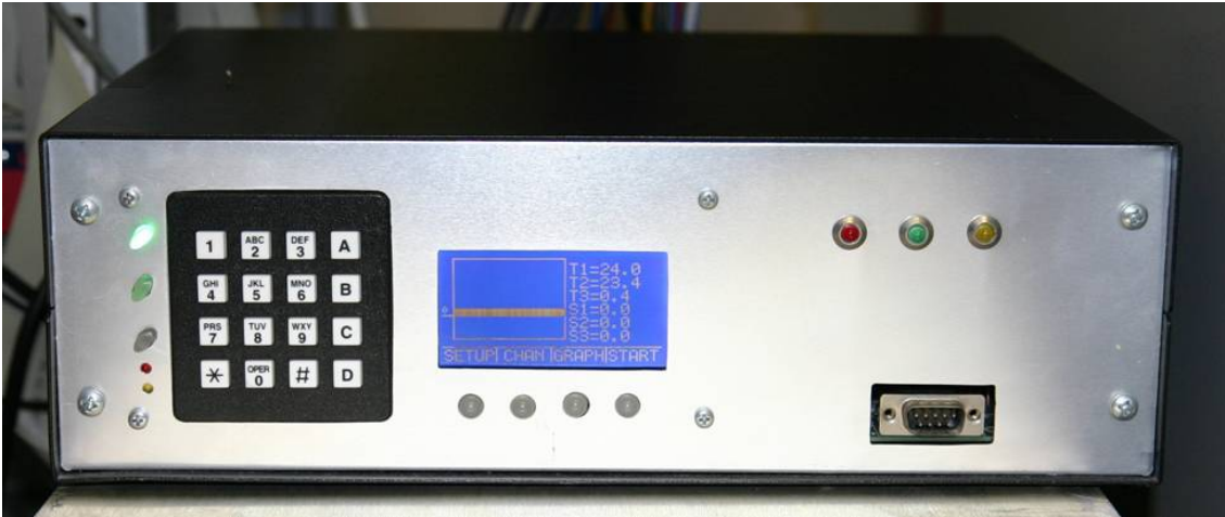
Fig. D1. Photo of the temperature controller.
