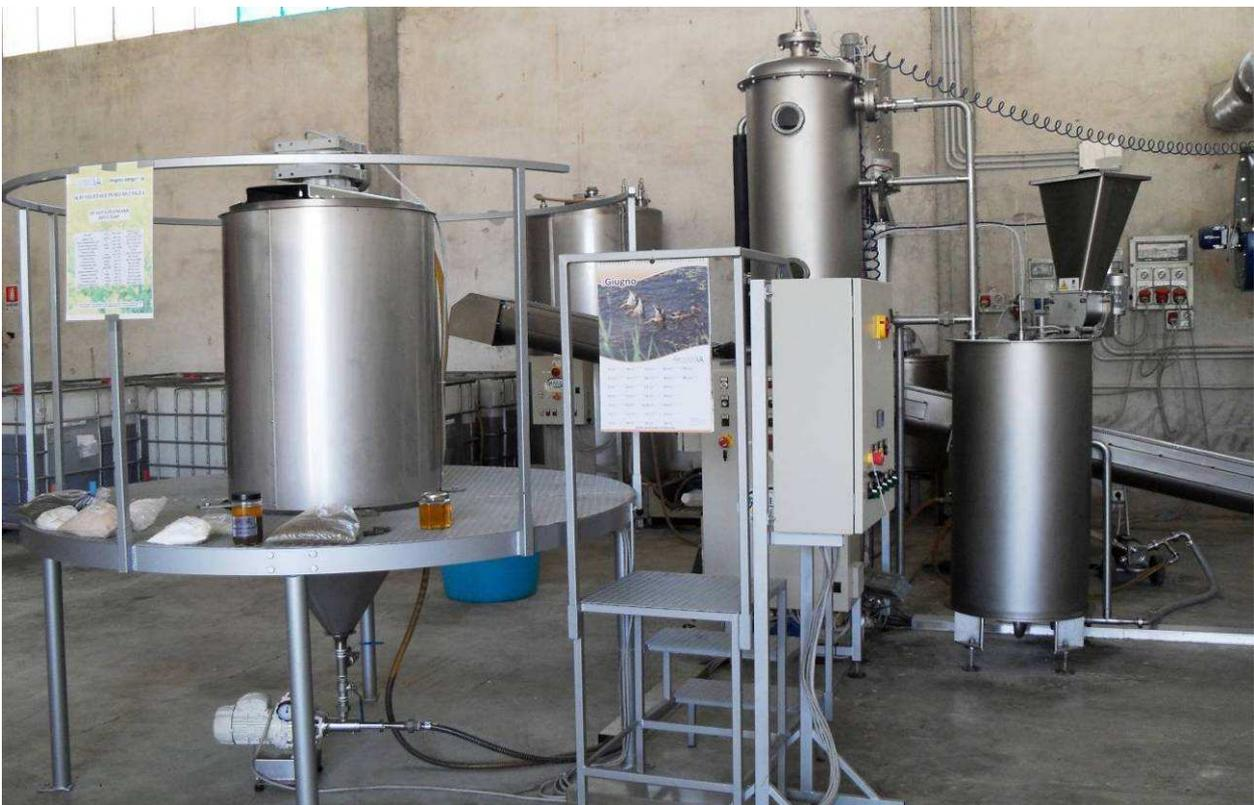
*Figura 33 - Vista generale dell'impianto; in primo piano sulla sinistra il decanter aggiuntivo per i fanghi*
