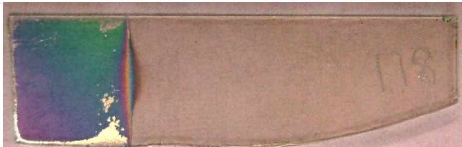
Figura 3.30: tipico campione per prove fotoelettrochimiche. E' possibile notare l'estesa delaminazione sul bordo del film.
