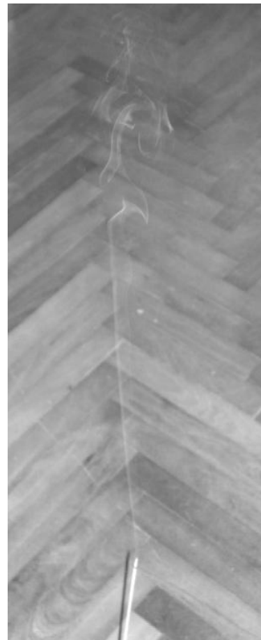
Figura 2.23: il fumo prodotto da un incenso ha un flusso prima laminare, poi turbolento.
