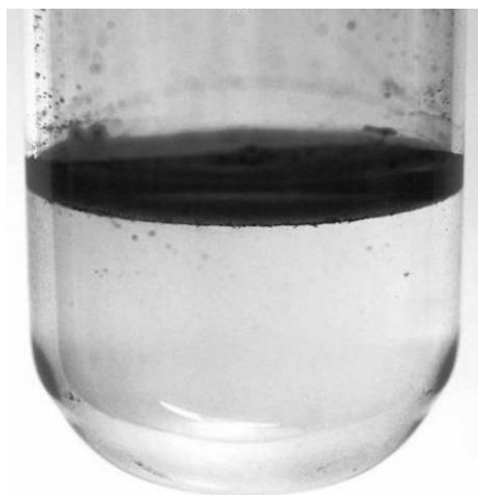
Figura 4.9: fotografia in cui è possibile osservare il comportamento idrofobico dei nanohorn in acqua.
