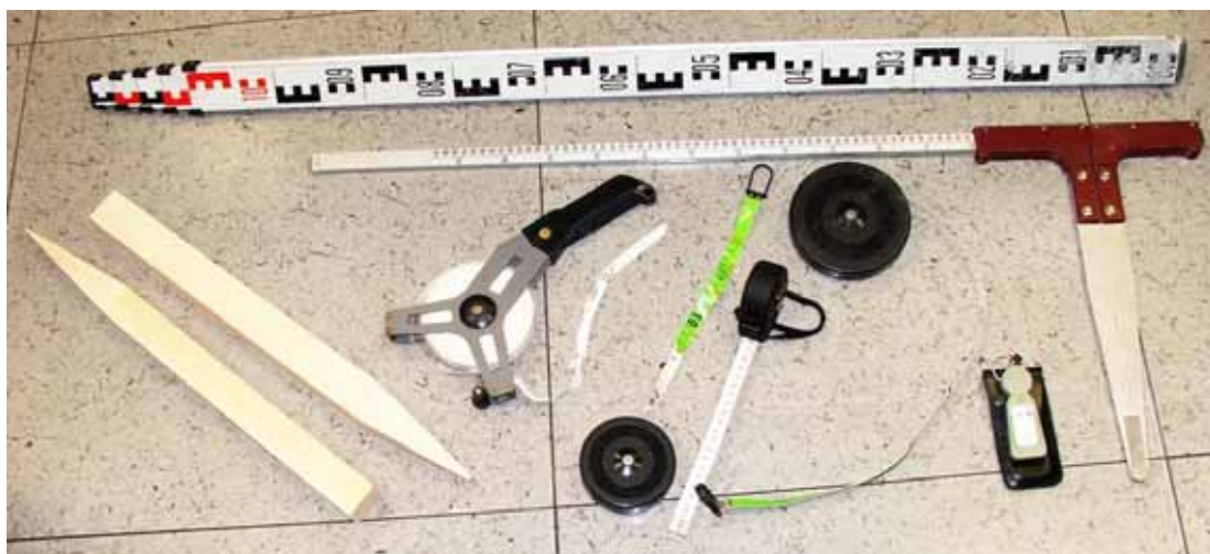
Figura 3.1 – Strumenti di misura utilizzati per il rilievo della morfologia d'alveo e degli elementi legnosi; Da sinistra: picchetti segnalatori, cordelle metriche, clisimetro, cavalletto forestale, asta telescopica.
