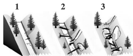
Figura 5.47 – Rappresentazione dell'indice di dissesto: 1 collettore stabile; 2 mediamente dissestato; 3 forte instabilità litologica
