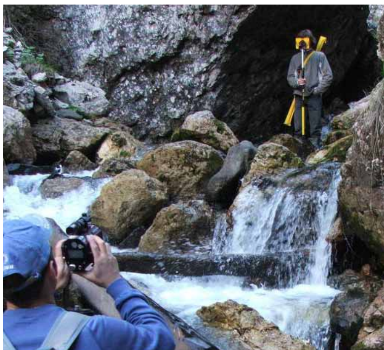
Figura 3.2 – Rilievo del profilo longitudinale di un tratto del Rù Davedin mediante distanziometro Impulse 200 Standard ® e riflettometro.
