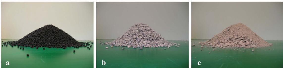
**Figura 4.6.** Materiali impiegati nei test di laboratorio: cilindretti di plastica (a), ghiaio (b) e matrice di depositi di colata detritica (c).
