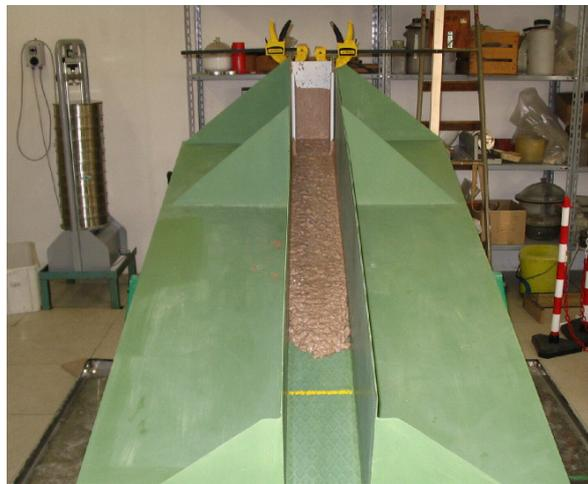
**Figura 4.24.** Prova con concentrazione volumetrica pari a 0.65, inclinazione  $15^\circ$  e lunghezza di corsa pari a 180 cm.
