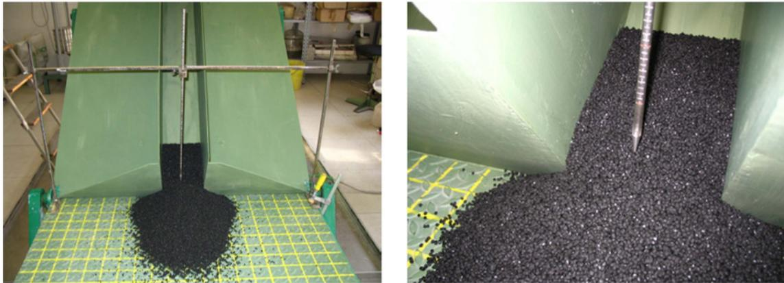
**Figura 4.5.** Lo strumento per la misurazione delle altezze del deposito (a sinistra); particolare dell'asta graduata (a destra).
