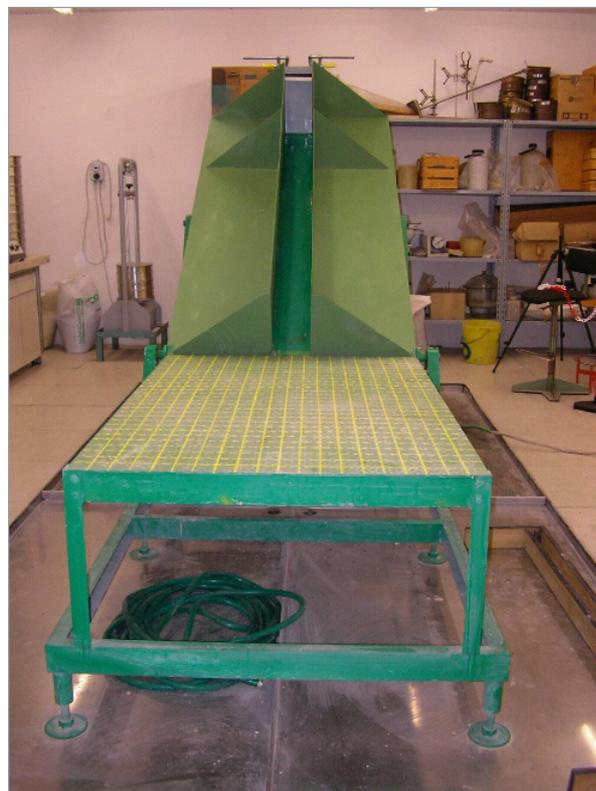
**Figura 4.3.** Il reometro a piano inclinato nella configurazione con canaletta artificiale.
