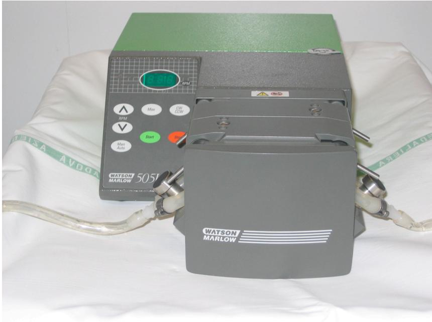
**Foto 7:** Pompa volumetrica rotativa Watson Marlow
