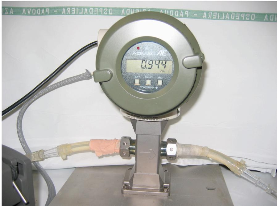
**Foto 9:** Flussimetro magnetico Admac AE
