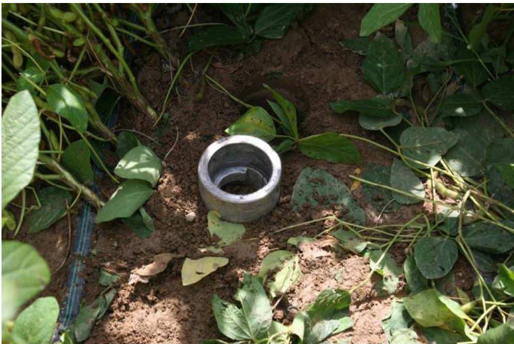
Figura 28: Sonda completamente inserita nel terreno.
