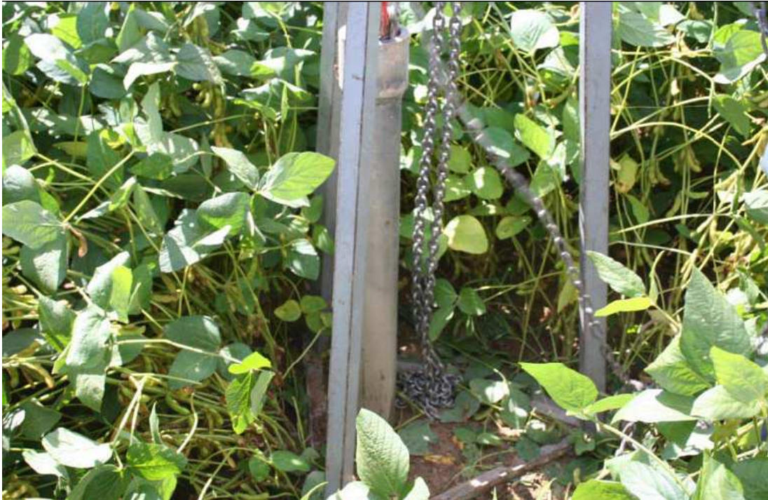
Figura 29.1: Estrazione della sonda dal terreno.
