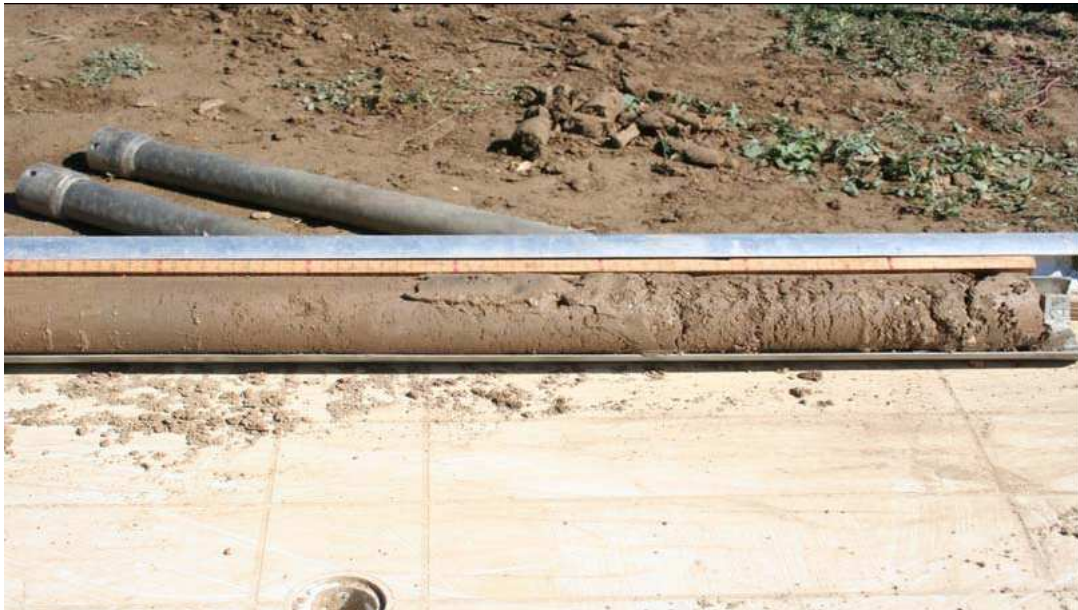
Figura 29.2: Camicia di alluminio contenete una carota campione di terreno.
