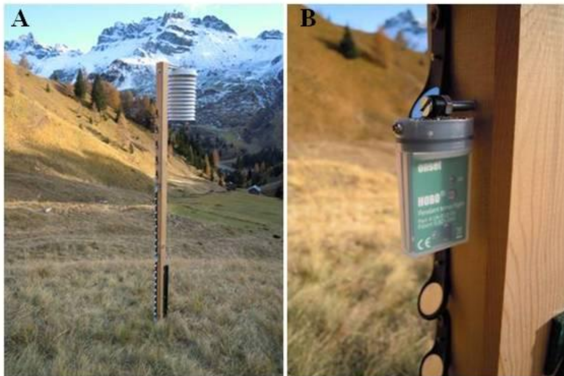
Fig. 82 L'asta sperimentale al Bacino del Vauz (A) e dettaglio del sensore HOBO Pendant® Temperature/Light Data Logger. Per la misurazione della temperatura dell'aria si è invece utilizzato un Tinytag Plus 2 temperature data logger (TGP-4020) connesso alla relativa sonda termometrica (PB-5001-1M5; accuratezza \pm 0.2^{\circ}\text{C} ).
