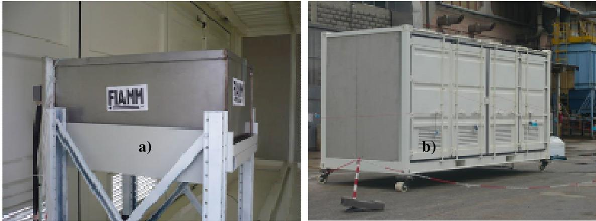
Figura 2.3.4.5-1 Test di corto circuito interno al modulo: a) modulo interno all'unità container b) Unità container
