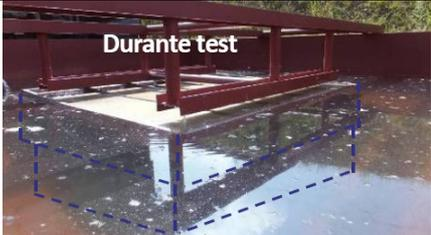
Durante test                                                                                          | <i>Immersione in acqua per 3 giorni<br/>Nessun danno alle celle all'interno del modulo</i>                                                             |
