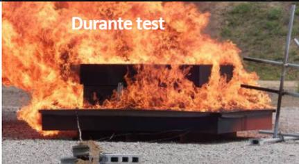
Durante test                                                                                          | <i>Esposizione al fuoco per 35 min con temperatura esterna di 890°C (max temp. interna = 360°C)<br/>Nessun danno alle celle all'interno del modulo</i> |
