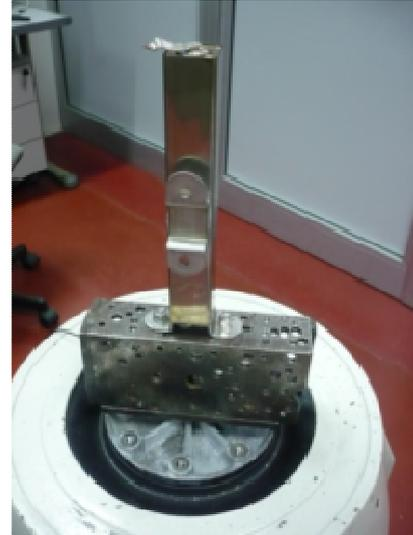
**Figura 2.3.4.1-1** Simulacro di prova per il test shock sulla cella
