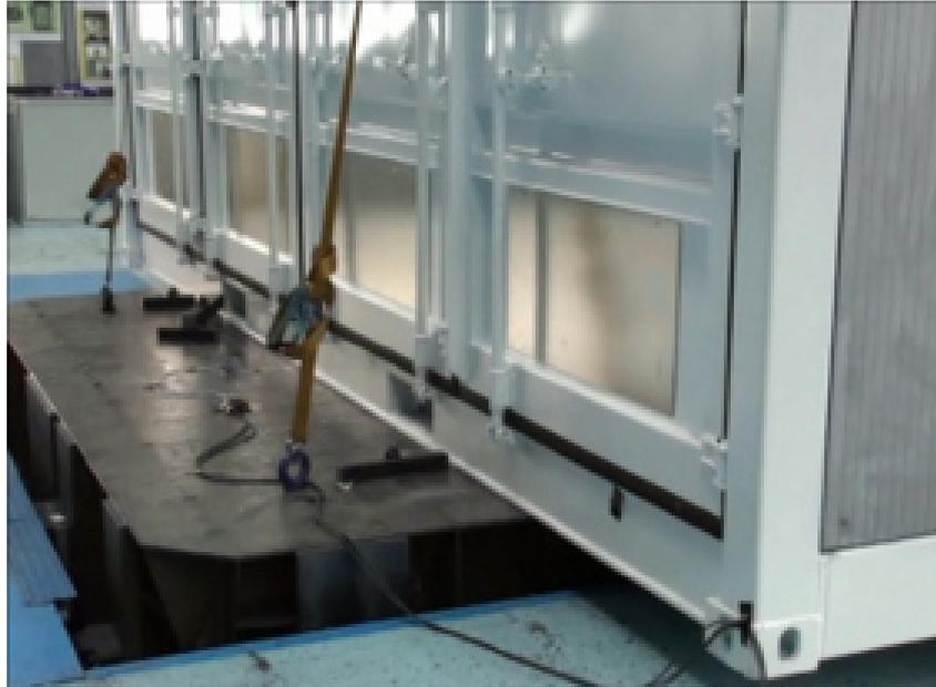
**Figura 2.3.4.6-3** Particolare del sistema di ancoraggio alla pedana mobile nel test di trasporto su gomma
