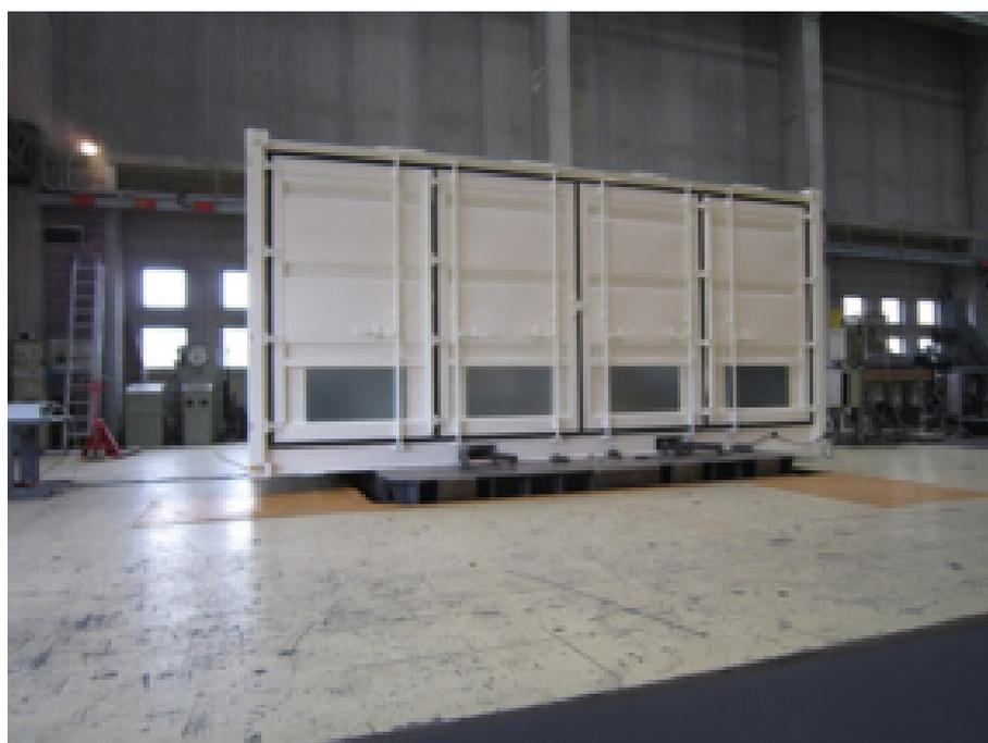
**Figura 2.3.4.6-2** Test di trasporto su gomma con unità container chiusa
