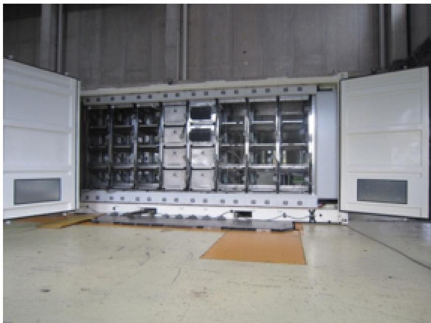
**Figura 2.3.4.6-1** Simulacro di prova: unità caricata con 16 batterie di cui 2 batterie ST523 e 14 batterie "dummy" di peso equivalente alle ST523
