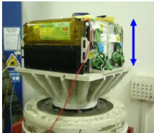
**Figura 2.3.4.1-3** Simulacro di prova per il test di shock sul modulo lungo l'asse verticale
