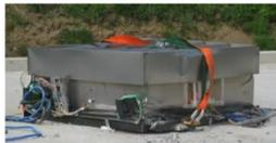
Dopo test | <i>La parte dell'involucro che ha subito la collisione è stato deformato;<br/>Nessuna cella si è fratturata all'interno del modulo</i>                 |
