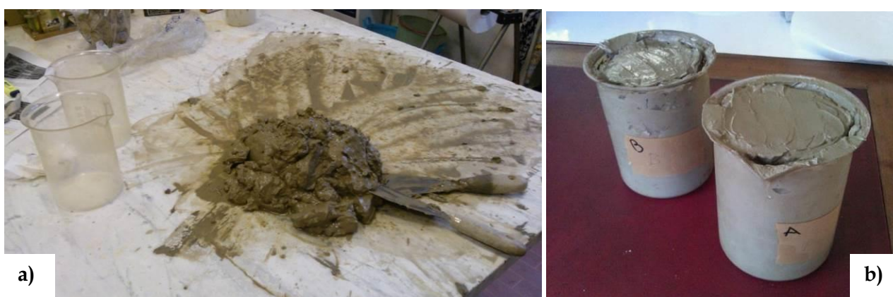
Figura 130: Durante la fase di preparazione del materiale Clay2: a) miscelazione con acqua deionizzata a formare una slurry ; b) i due provini di materiale Clay2A e Clay2B, pronti per la misura.
