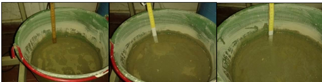
Figura 86: Sedimentazione del materiale all'interno del recipiente, nel corso del secondo lavaggio. Il livello del materiale depositato è 4,5cm, 6cm e 8cm, rispettivamente al termine del 1°, 2° e del 4° giorno.
