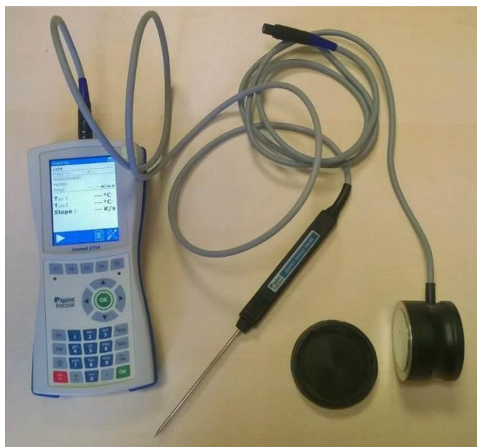
Figura 127: La sonda ISOMET utilizzata per le misure sperimentali, con le due sonde ad ago (per i materiali sciolti) e circolare piana (per campioni di roccia).
