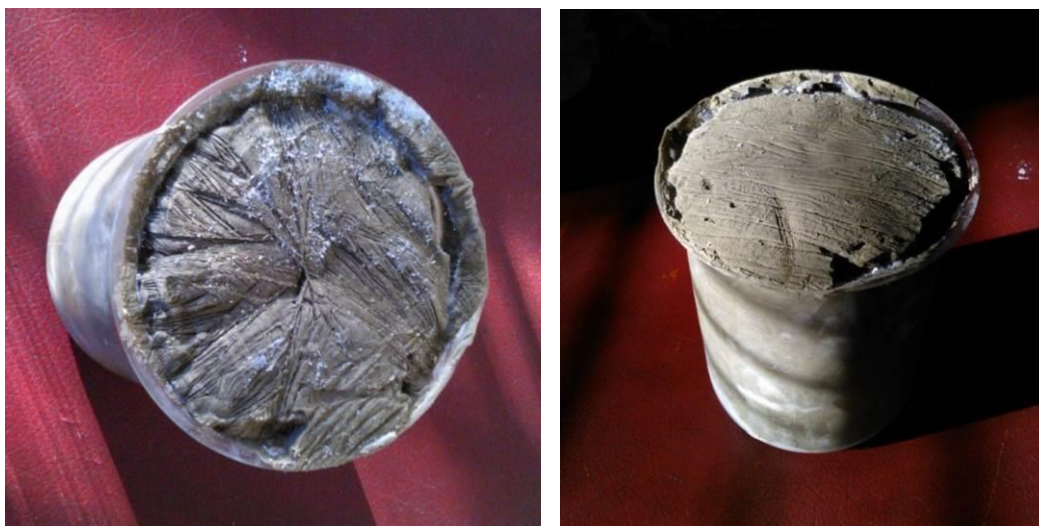
Figura 132: L'aspetto della superficie del campione in condizioni ghiacciate, si osserva il rigonfiamento e la formazione dei filamenti di ghiaccio, che hanno ostacolato l'andamento delle misure impedendo un contatto ottimale tra sonda piana e materiale.
