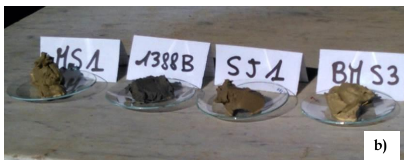
Figura 58: Alcune fasi della caratterizzazione geotecnica dei campioni di materiale: a) determinazione della curva granulometrica per sedimentazione in acqua; b) campioni per la misura del contenuto d'acqua al limite liquido.
