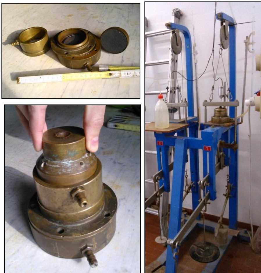
Figura 53: L'edometro (sinistra) utilizzato per la misura del processo di consolidazione e il sistema di leve per l'applicazione del carico (destra).
