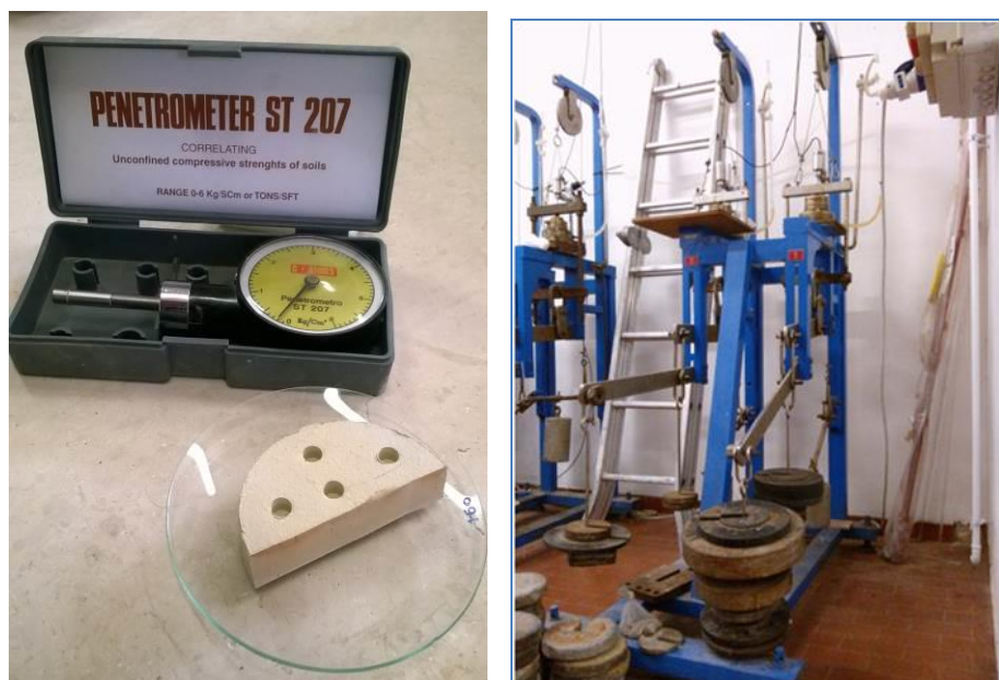
Figura 75: (a) Misura della resistenza al pocket penetrometer sul provino gemello; (b) sistema di carico con il carico applicato di 2400kPa durante la fase di sovraconsolidazione del provino, prima di inserirlo nella cella termostata.
