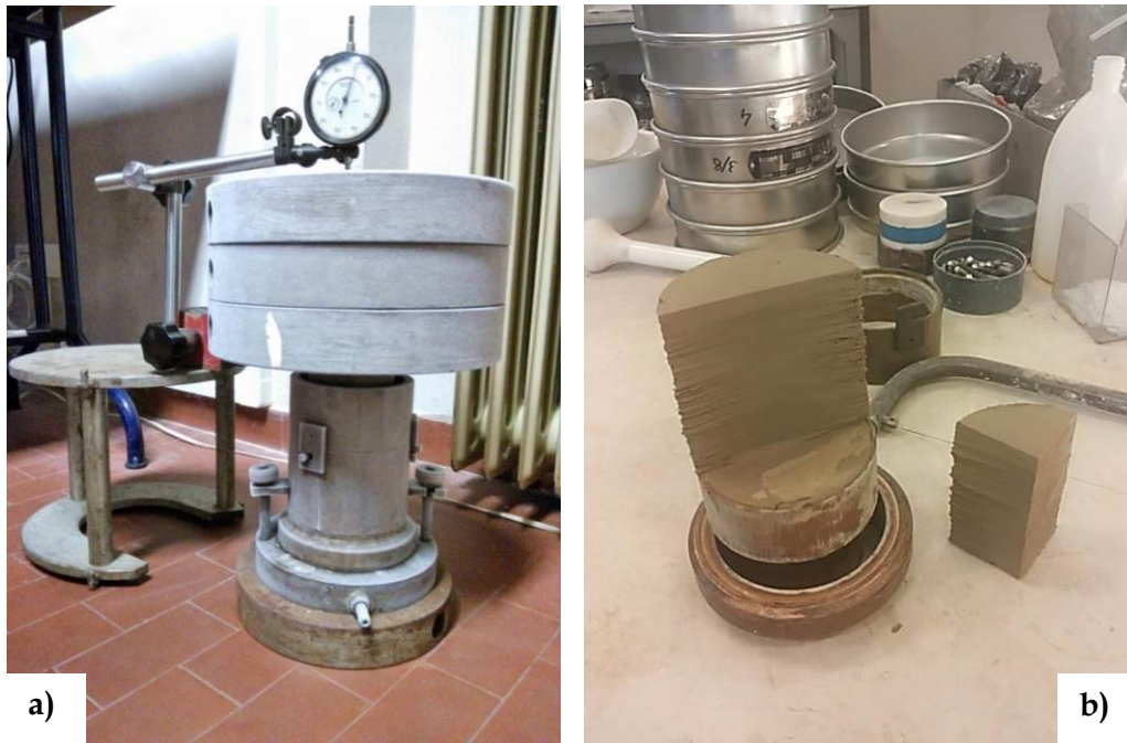
Figura 100: Consolidometro in fase di scongelamento sotto carico (a), e taglio del terreno per preparare i provini per le prove triassiali nel materiale che ha subito la consolidazione dovuta ai cicli di gelo e disgelo, a cui si possono attribuire le striature orizzontali che si possono osservare nell'immagine (b), assenti nel materiale naturale.
