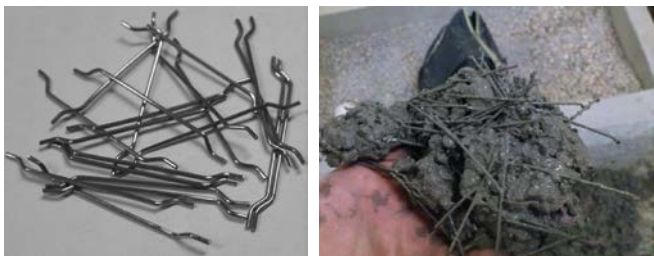
Figura 2. Fibras de acero utilizadas, (Carrillo & Díaz, 2014)
