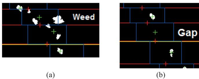
**Figura 6** Ejemplos de casos especiales. (a) Presencia de maleza dentro de la micro-ROI; (b) Vacíos (ausencia de objetos etiquetados) dentro de la micro-ROI.
