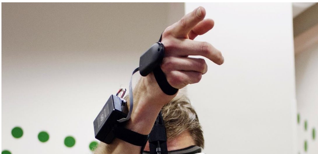
Joonis 2.2 Kahest osast koosnev klientseade küünarvarre ja labakäe suuna jälgimiseks.
