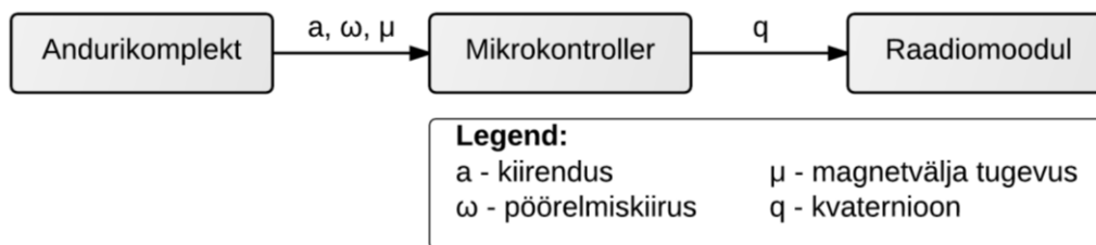
Joonis 2.3 Andmete liikumine klientseadmes
