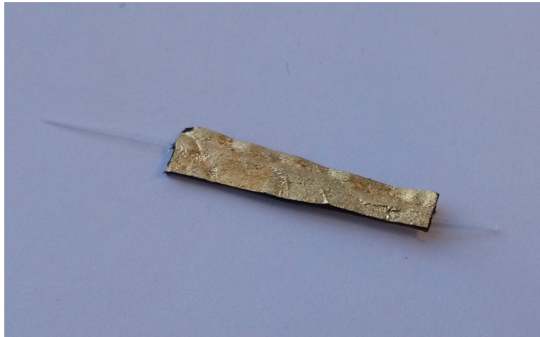
Joonis 8. Pehme aktiivpipetiotsik välja lõigutuna.
