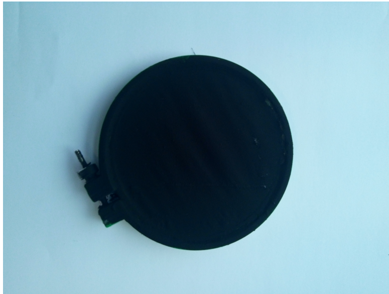
Joonis 6. Pipeti valmistamisprotsessis on elektroodid pihustatud membraanile.
