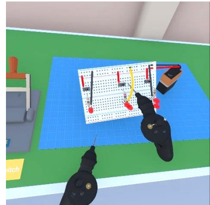
Joonis 2: Kuvatõmmis programmis ShortCircuit VR elektriskeemi kokkupanemisest
