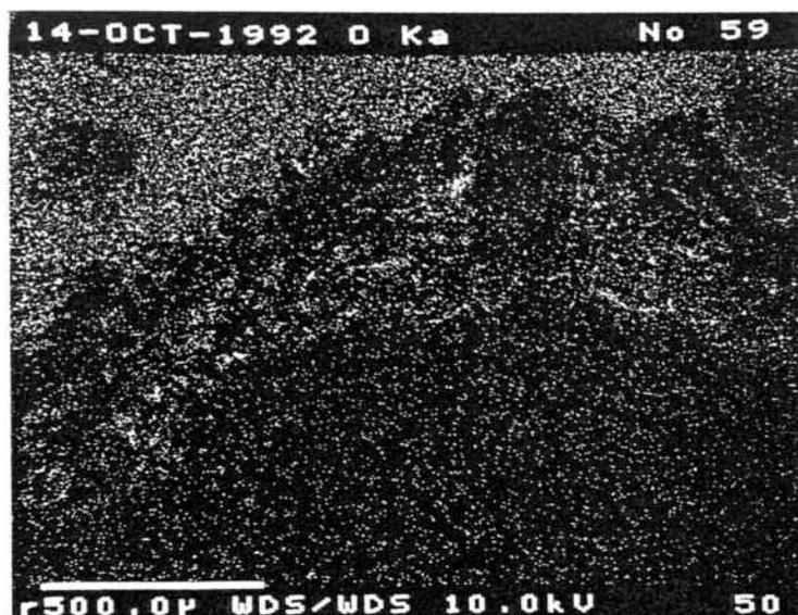
Figura 72-D.- Distribución del oxígeno en la Figura 72-A. (X53).
