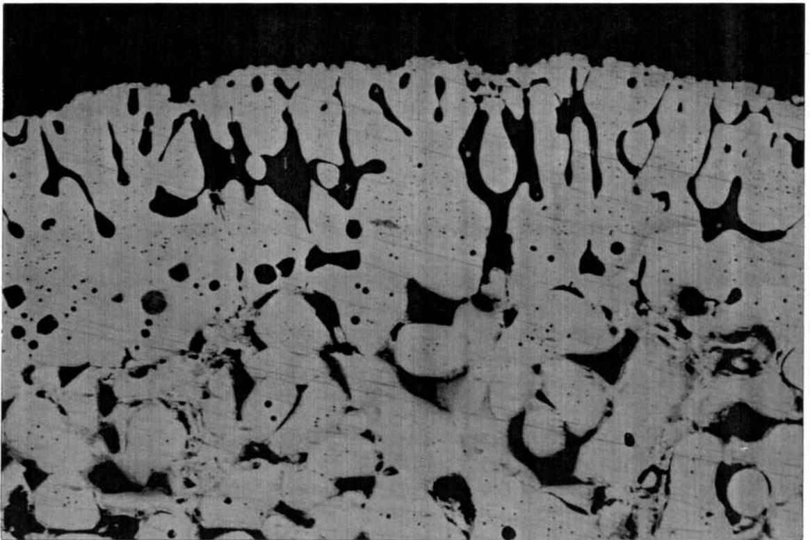
Figura 68.- Detalle de la capa externa formada en una partícula de  $\text{Ag}_2\text{Se}$  después de tostarla a  $700^\circ\text{C}$ . (X108).
