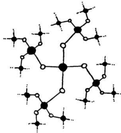
Figura 14. Topología de la red de Bethe. En negro los átomos de Si.
