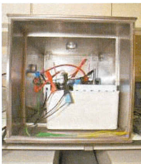
Figura 5 – Fotografías del baño/termostato y jaula de Faraday
