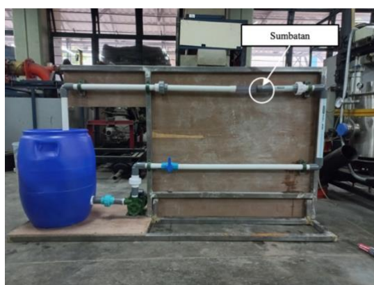
Gambar 3. Instalasi pompa pada pengujian variasi jarak sumbatan pada pipa yang disumbat
