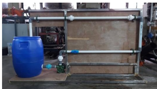
Gambar 2. Instalasi pompa pada pengujian variasi diameter pipa
