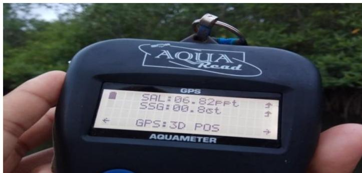
Gambar 8. Pengukuran salinitas
