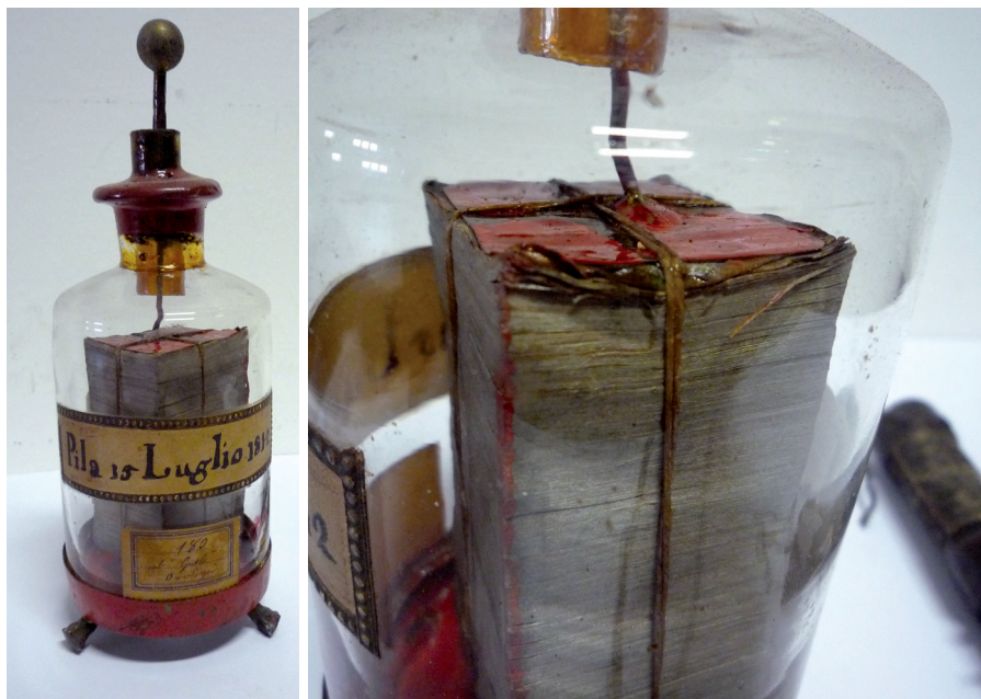
Figg. 9 e 10. Pila a secco di Zamboni (con particolare), datata 15 luglio 1812. E' la più antica che si conosca.
