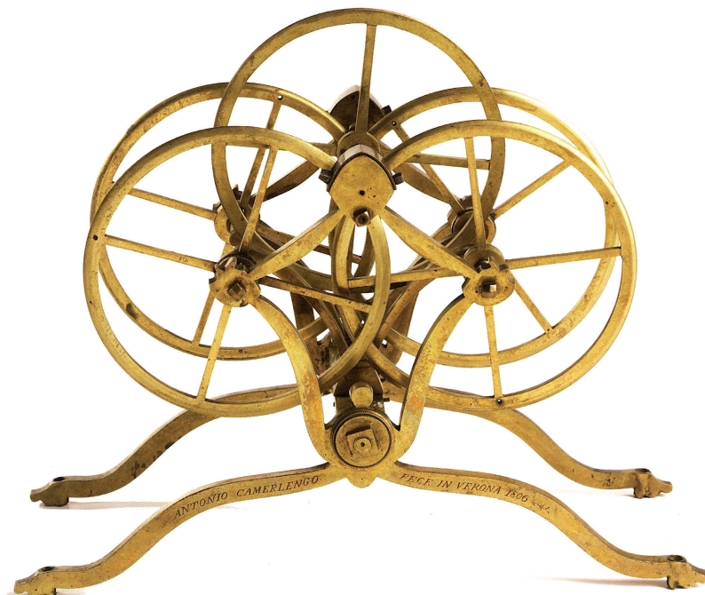
Fig. 16. Tribometro. E' firmato "Antonio Camerlengo fece in Verona 1806".
