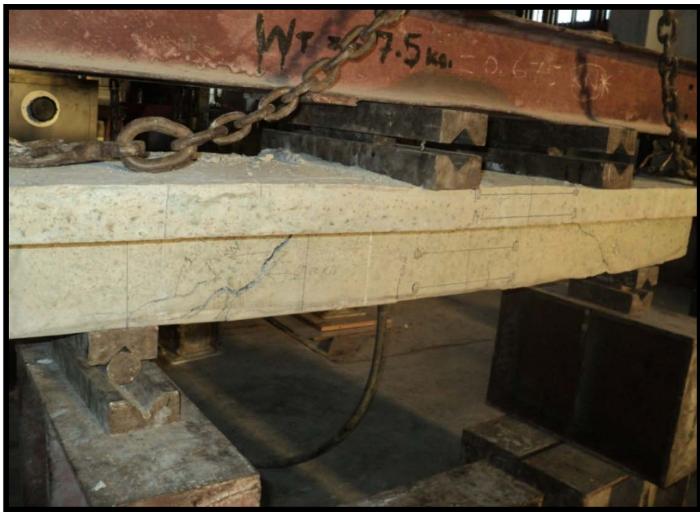
(d) Crack Pattern at ultimate failure of specimen CB
