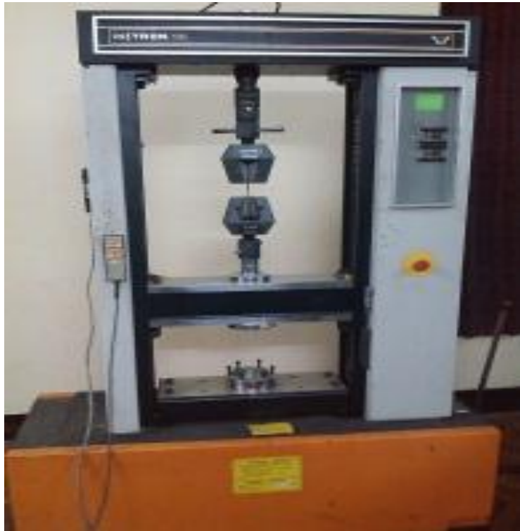
Fig 3.4.2; Tensile testing (Instron-1195)
