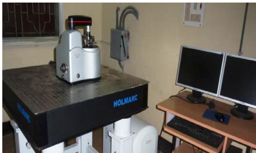
Figure 3.3: VEECO di Innova atomic force microscope.
