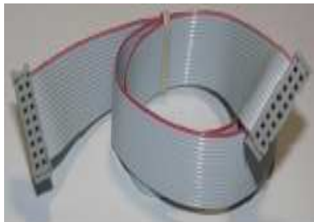
Fig. 3.10 Digital I/O Cables
