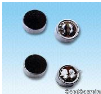
Figure: 8 (condenser mike)
