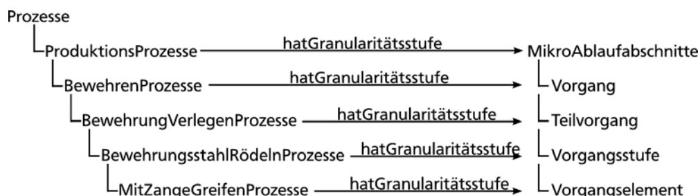
Bild 5 Zuordnung von Produktionsprozessen zu Mikroablaufabschnitten
