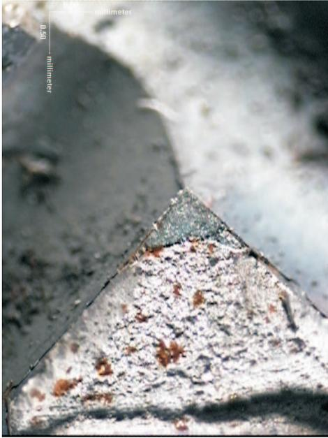
**Bild A.121.** Geometrie stehbleibender Riss, 90° BV (18CrNiMo7-6), Probe 209, Durchläufer  $\Delta p = 2950$  bar, [71, Bild A.65]
