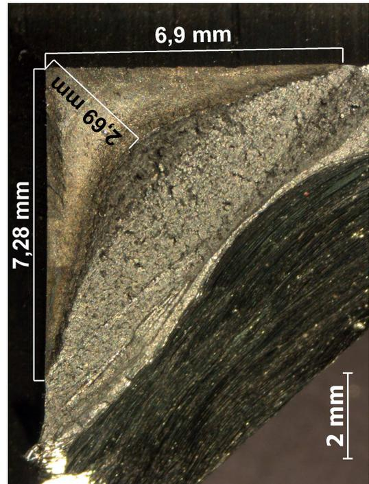
**Bild A.114.** Geometrie stehbleibender Riss, 90° BV (42CrMo4), Probe 4 - Ecke 2, Durchläufer  $\Delta p = 3000$  bar, Tabelle A.24
