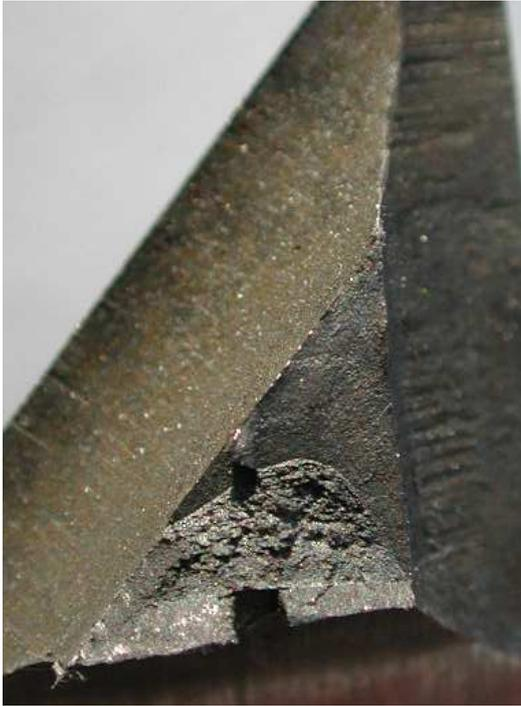
**Bild A.108.** Risstopp an 45° Bohrungsver-schneidung,  $h/d = 15/5$ , aus [107, Bild 5.14] und [276, Bild 2]
