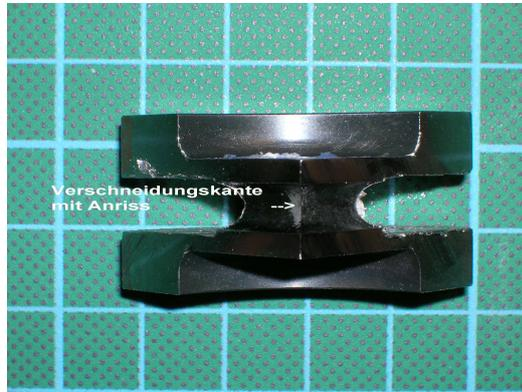
**Bild 4.20.** Ansicht eines Probenstückes, präpariert zum Aufbrechen
