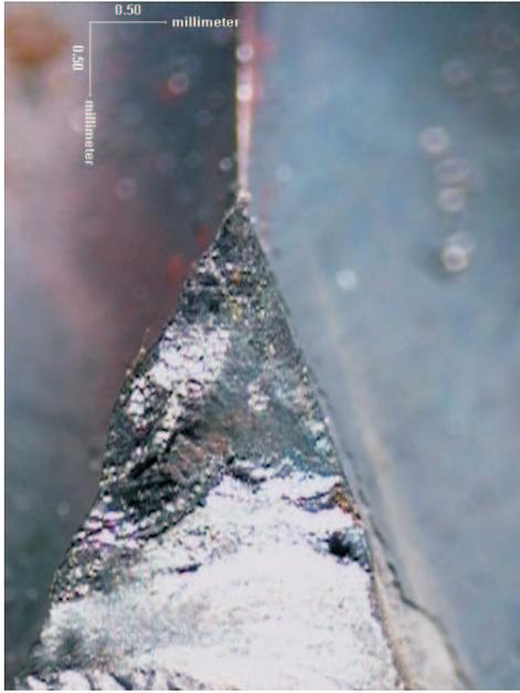
**Bild A.117.** Geometrie stehenbleibender Riss, 45° BV (18CrNiMo7-6), Probe 391, Durchläufer  $\Delta p = 2950$  bar, [71, Bild A.64]
