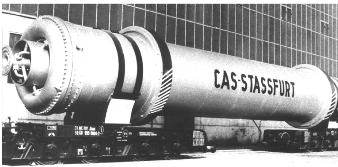
Bild 1 Dampfrohrenkalzinator 400t/d, im Betrieb komplett montiert
