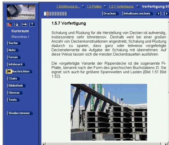
Abbildung 3: Auszug aus dem Skript Massivbau I, Vorfertigung
