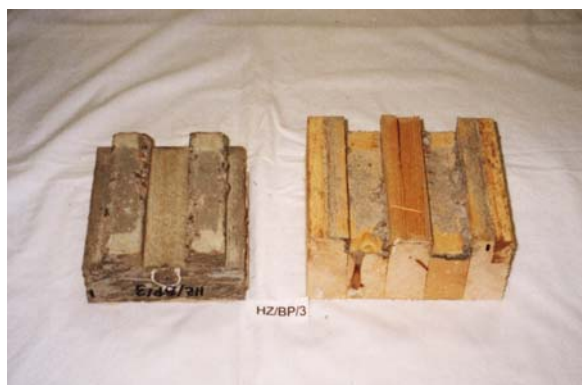
Abb.C.4-17: Bruchbilder links des Probekörpers HZ/BP/3 und rechts des Probekörpers HZ/ZP/4
