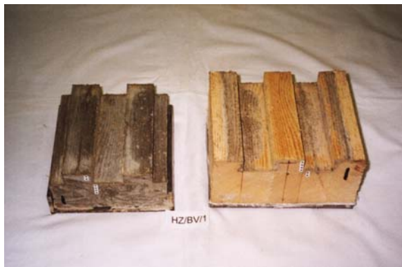
Abb.C.4-15: Bruchbilder links des Probekörpers HZ/BV/1 und rechts des Probekörpers HZ/ZV/1
