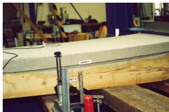
Abb.5-39: Abheben der Deckschicht vom Holzelement im Versagenszustand
