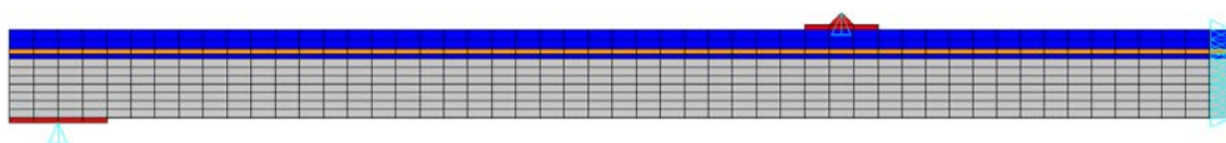
Abb.5-15: Diskretisierung des Verbundbauteils unter Symmetriebedingung
