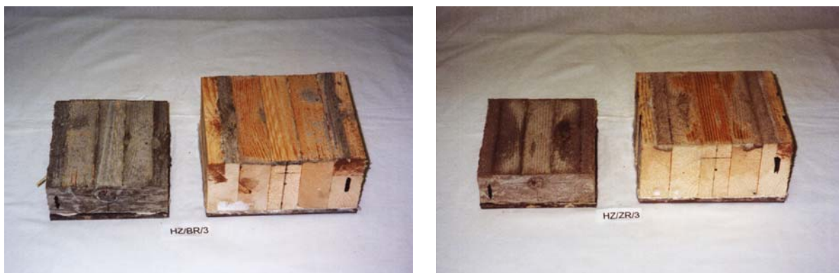
Abb.C.4-13: Bruchbilder links des Probekörpers HZ/BR/3 und rechts des Probekörpers HZ/ZR/3
