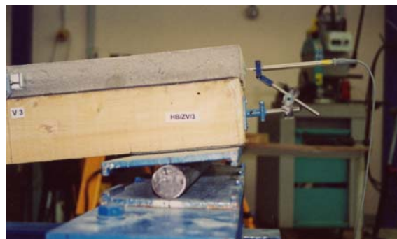
Abb.5-26: Induktiver Wegaufnehmer zur Messung der Relativverschiebung an den Stirnseiten
