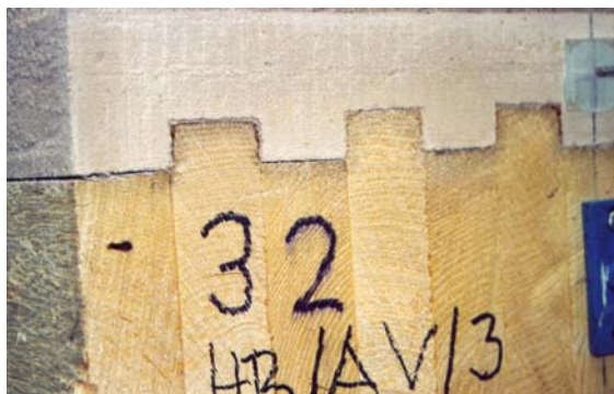
Abb.5-46: Geschlossene Verbundfuge am Verbundelement vor der Prüfung
