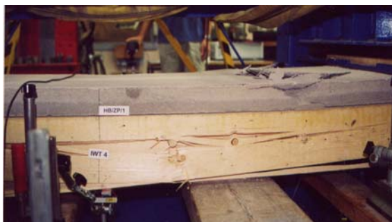
Abb.5-44: Biegedruckbruch im Zementestrich und gebrochene Randlamelle
