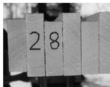
Abb.5-10: Brettstapelelement des Typs V mit gebogener Randlamelle
