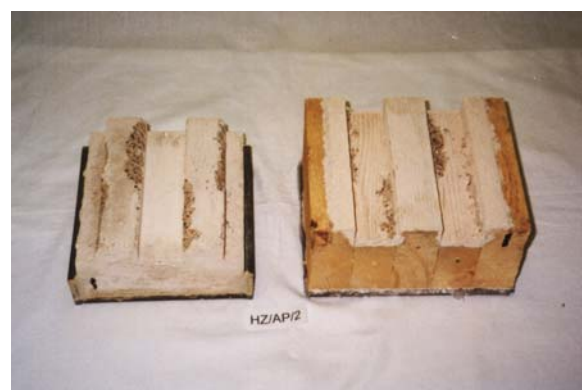
Abb.C.4-18: Bruchbilder links des Probekörpers HZ/AP/2 und rechts des Probekörpers HZ/GP/2
