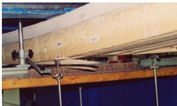
Abb.5-25: Induktiver Wegaufnehmer zur Messung der Durchbiegung
