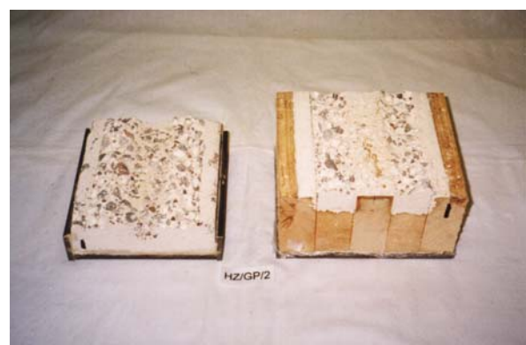
Abb.C.4-18: Bruchbilder links des Probekörpers HZ/AP/2 und rechts des Probekörpers HZ/GP/2
