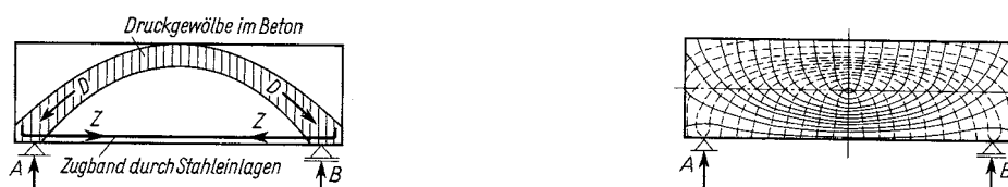
Abb.5-14 Zugband mit Druckbogen und dem Verlauf der Spannungstrajektorien im Stahlbetonbalken aus [Iohm_1]
