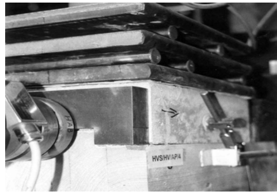
Abb.3-9: Lasteinleitung bei höhenversetzter Lamellenanordnung
