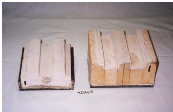
Abb.C.4-16: Bruchbilder links des Probekörpers HZ/AV/3 und rechts des Probekörpers HZ/GV/1
