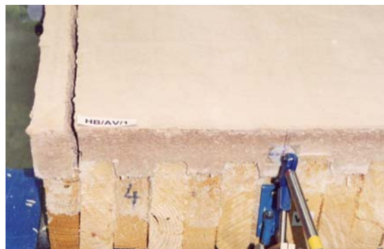
Abb.5-47: Längsriss in der Anhydritestrichschicht am Probekörper HB/AV/1
