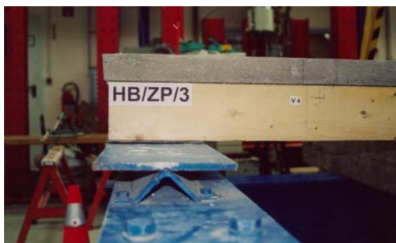
Abb.5-23: Auflagerung der Versuchskörper auf einem Kipplager (unverschieblich)
