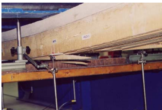
Abb.5-41: Geschlossene Fuge und zerstörte Biegezugzone im Brettstapelement
