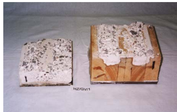
Abb.C.4-16: Bruchbilder links des Probekörpers HZ/AV/3 und rechts des Probekörpers HZ/GV/1
