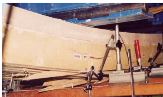
Abb.5-51: Geschlossene Fuge bei großer Durchbiegung und gerissener Zugzone
