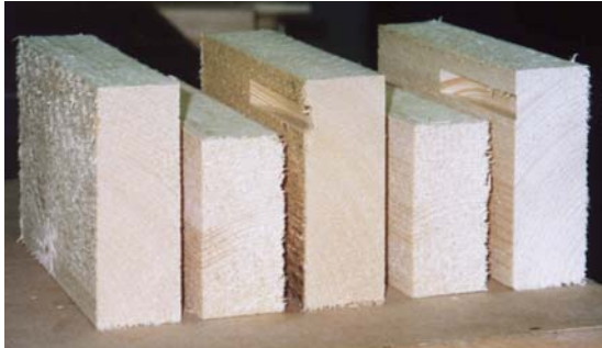
Abb.4-7: Alternierende Lamellen mit Profilierung
