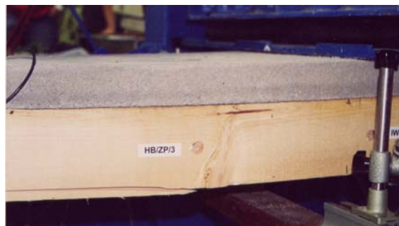
Abb.5-45: Ast in einer einzelnen Lamelle in der Biegezugzone
