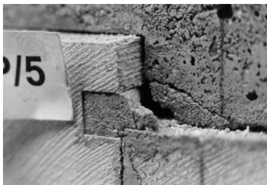
Abb.3-36: Betonrückstände am Holz am Beispiel von HVS/BP/5
