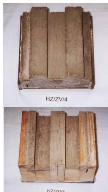
Abb.4-25: Deckschichtseitiger Grenzschichtbruch am Beispiel von HZ/ZV/4
