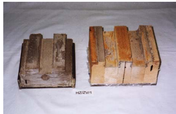
Abb.C.4-15: Bruchbilder links des Probekörpers HZ/BV/1 und rechts des Probekörpers HZ/ZV/1
