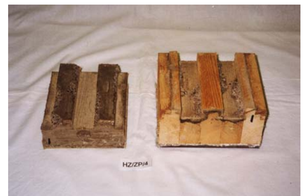
Abb.C.4-17: Bruchbilder links des Probekörpers HZ/BP/3 und rechts des Probekörpers HZ/ZP/4
