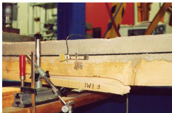
Abb.5-33: Abheben der Betonplatte zwischen den Lasteinleitungspunkten
