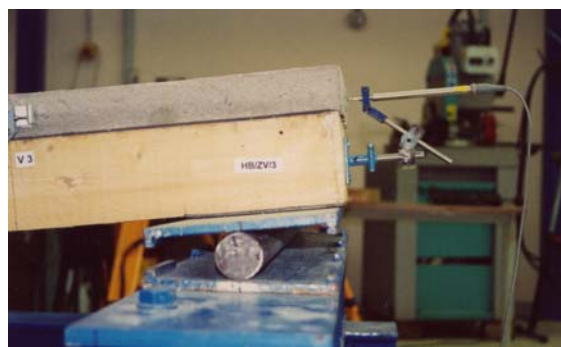
Abb.5-24: Auflagerung der Versuchskörper auf einem Rollenlager
