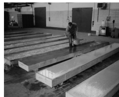
Abb.5-13: Frische Deckschicht und Nachbehandlung
