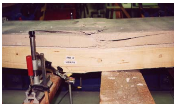
Abb.5-50: Versagen der Biegezug- und Druckzone in Plattenmitte
