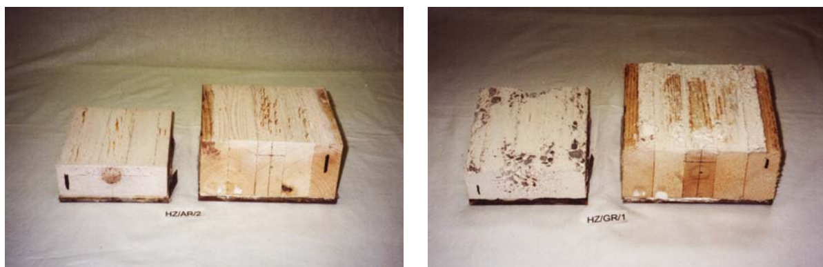
Abb.C.4-14: Bruchbilder links des Probekörpers HZ/AR/2 und rechts des Probekörpers HZ/GR/1
