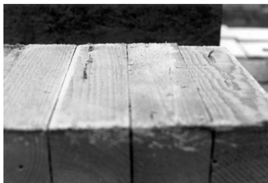
Abb.3-37: Aufgeriebene Holzoberfläche am Beispiel von HVS/GR/8
