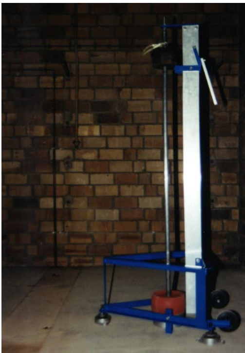
Abbildung 5.4: Konstruktion des Impulshammers
