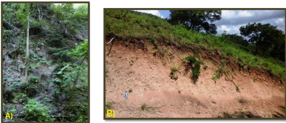
Foto No.1-1. Obsérvese en el margen izquierdo (A) un espesor de suelo aproximadamente de 10 m mientras que en el margen derecho (B) presenta 3 m. El primero se ubica a unos 0.5 km y el segundo a 1.3 km del área donde establecieron las mediciones.
