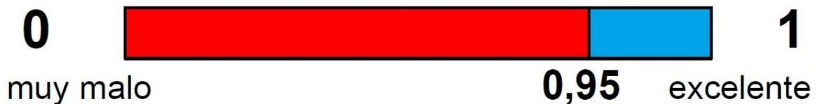
Por ejemplo, si el Factor de Potencia es 0,95 indica que del total de la energía abastecida por la Distribuidora sólo el 95 % de la energía es utilizada por el Cliente mientras que el 5 % restante es energía que se desaprovecha.
