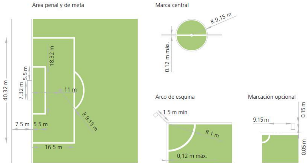
Ilustración 7. Detalles del terreno de juego Fuente: Recomendaciones técnicas y requisitos FIFA 5ª edición 2011
