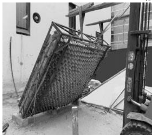
Imagen No. 96: Ensayo preliminar de volteo en muros de botellas. Fuente: “Nuevas alternativas en la construcción: botellas PET con relleno de tierra.”
