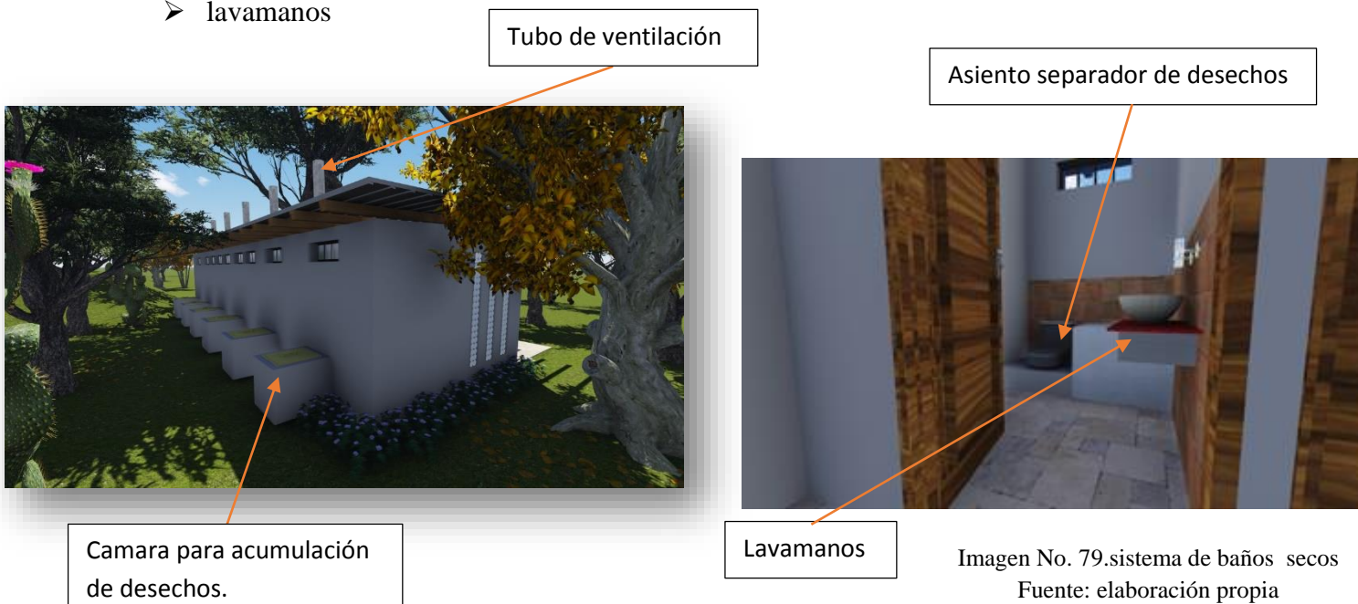
Imagen No. 83.sistema de baños secos Fuente: elaboración propia
