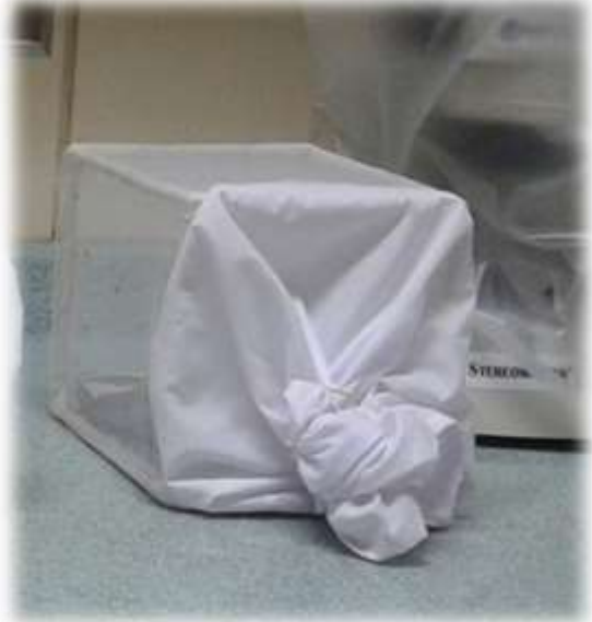
Fig.9 Jaulas de hierro de 15x20 Cm. forradas con tela de tul
