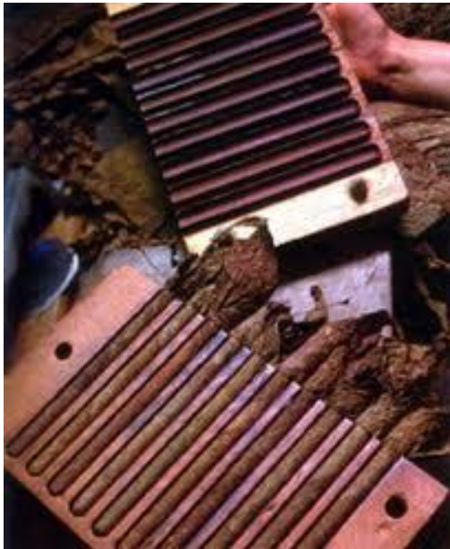
Colocación en moldes de madera
