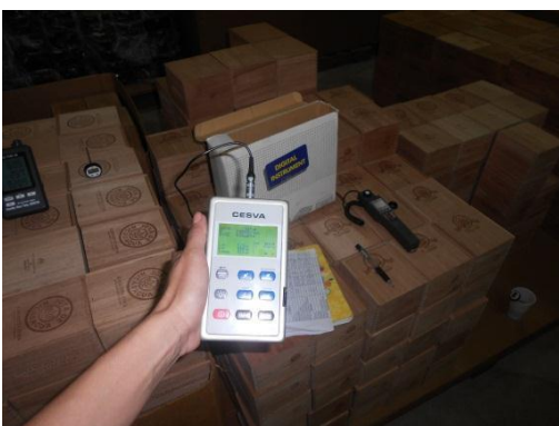
Medición del nivel sonoro bodega de materiales
