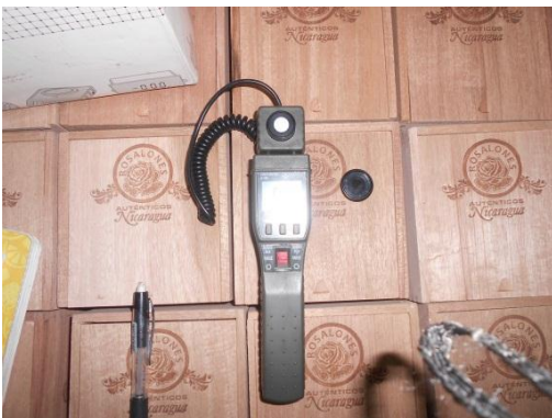
Medición de la iluminación en bodega de materiales
