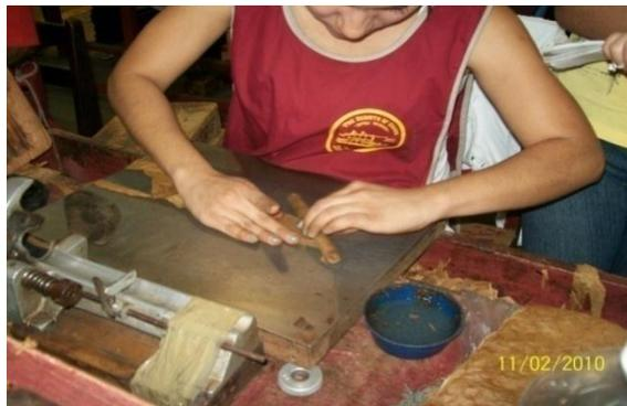
En el àrea de producciòn el bonchado de puros se trabaja con la picadura y con el capote que es sacado del area de capa, seguidamente las roleras proceden a trabajar con la capa.
