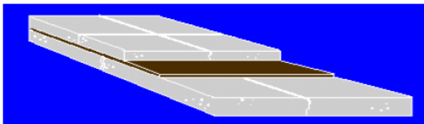
Figura 9.5 Sobre capa de concreto no adherida
