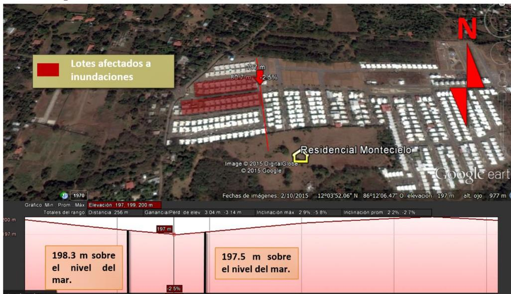
**Imagen 22.** Topografía del terreno del mínimo de 2.2 % y máximo del 5.8 %
