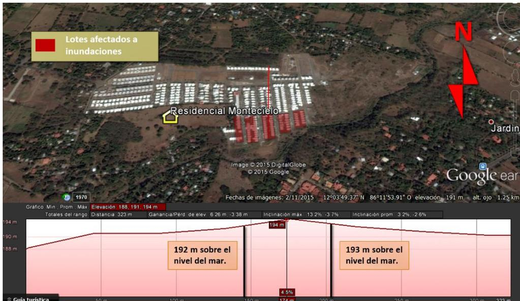
**Imagen 21.** Topografía del terreno del mínimo de 2.6 % y máximo del 13.2 %
