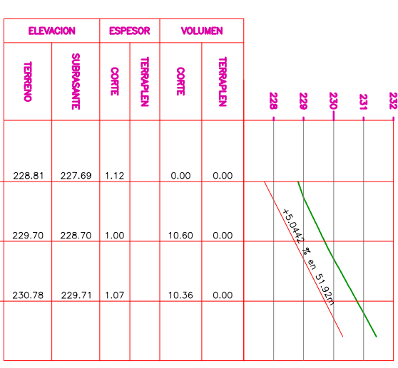
PERFIL TRAMO DE 16 A 2 ESCALA HORIZONTAL 1 : 1000 ESCALA VERTICAL 1 : 100 TOTAL VOLUMEN CORTE = 83.83m 3 TOTAL VOLUMEN TERRAPLEN = 0.00m 3
