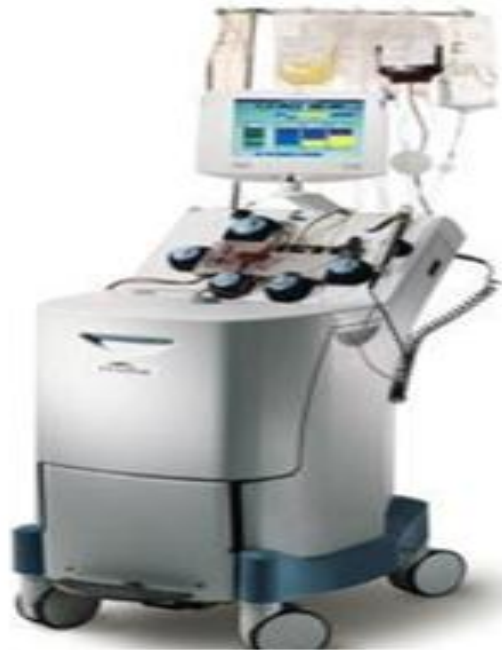
Figura 3. Esquema representativo del Equipo de Aféresis de Flujo Discontinuo Cobe Trima Accel
