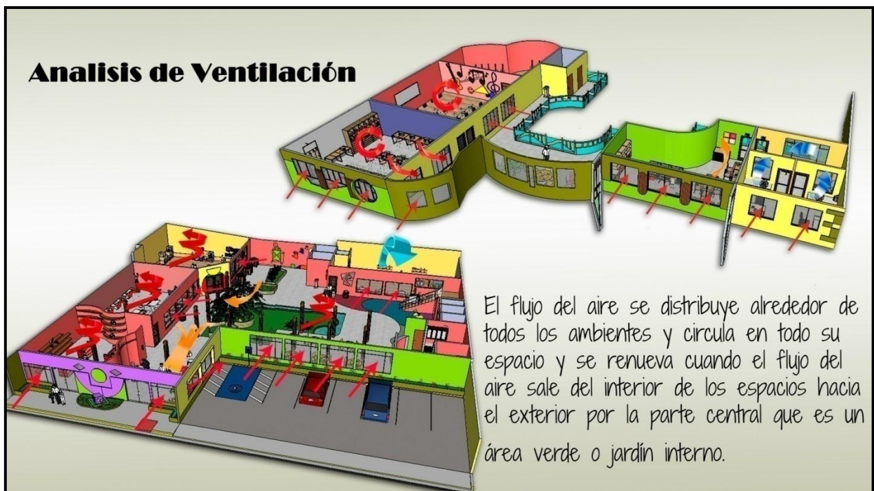
Imagen N° 71. Análisis de ventilación Fuente: Elaborado por grupo
