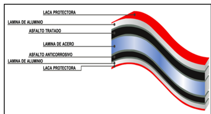
Imagen N° 15. Estructura del techo termo acústico Fuente: www.tacustico.com
